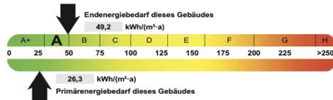
**Anforderungen gemäß EnEV<sup>4</sup>****Primärenergiebedarf**Ist-Wert 26,3 kWh/(m<sup>2</sup>·a) Anforderungswert 38,7 kWh/(m<sup>2</sup>·a)**Energetische Qualität der Gebäudehülle H<sub>t</sub><sup>2</sup>**Ist-Wert 0,26 W/(m<sup>2</sup>·K) Anforderungswert 0,39 W/(m<sup>2</sup>·K)Sommerlicher Wärmeschutz (bei Neubau)  eingehalten**Für Energiebedarfsberechnungen verwendetes Verfahren**
